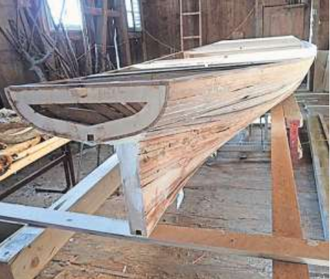
Christoph Rohrer baut den Mississippi-Raddampfer unten rechts als 6,2 Meter langes Modell nach. Der Rumpf (unten links) entsteht, ebenso die Radschaufeln (oben), wovon eine bei einem Durchmesser von 85 Zentimetern 35 Kilo wiegt. Bilder: PD
